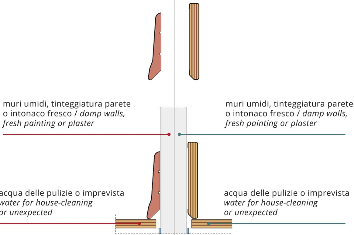
supporto in MDF che può deformarsi / *the support in medium density fibreboard can be deformed*
