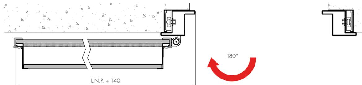
**Gradi di apertura minima per mantenimento L.N.P.**
