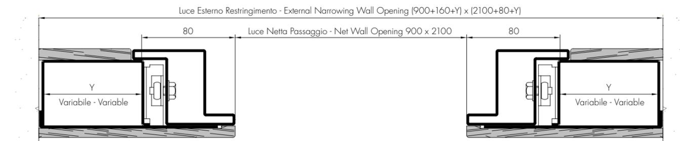
**Caso indicato per il montaggio in sostituzione su stipite in legno, marmo o muro vivo**
