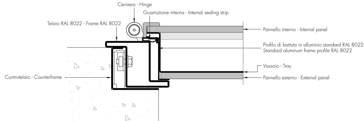
**Nodo telaio con doppia guarnizione per porta con Kit MOSE (acqua-aria-vento)**
