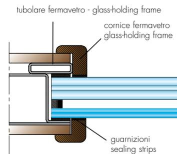
SEZIONE PANNELLI LINEA PANTOGRAFATO
