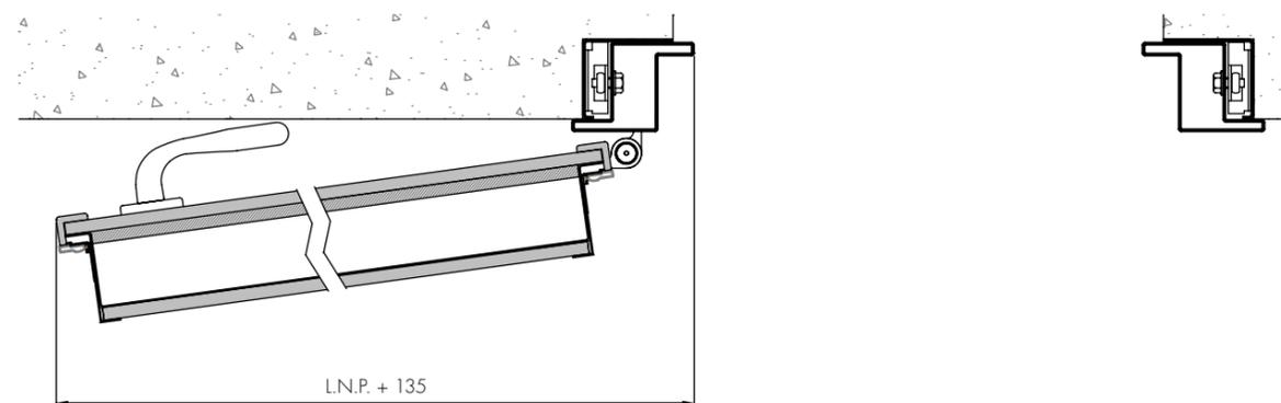
**Massimo ingombro per porta a due ante con apertura a 90° con pannello esterno spessore 10 mm**
