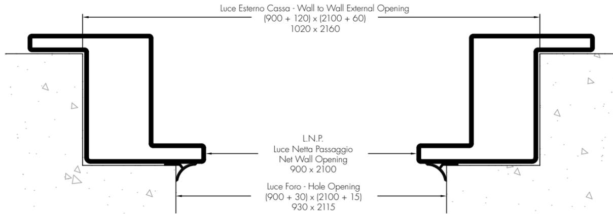
**Montaggio in luce senza controtelaio**
