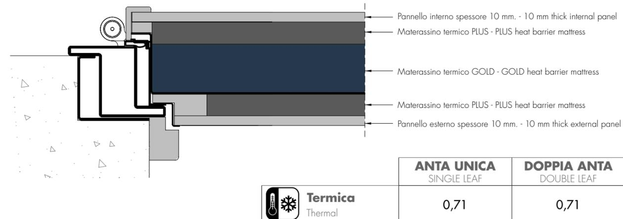
TIPOLOGIE DI MONTAGGIO - TYPES OF FITTING
