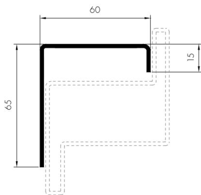
**E3E1** SEZIONE CONTROTELAIO
