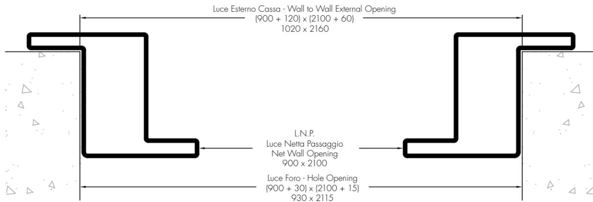
**A Telaio e controtelaio**
