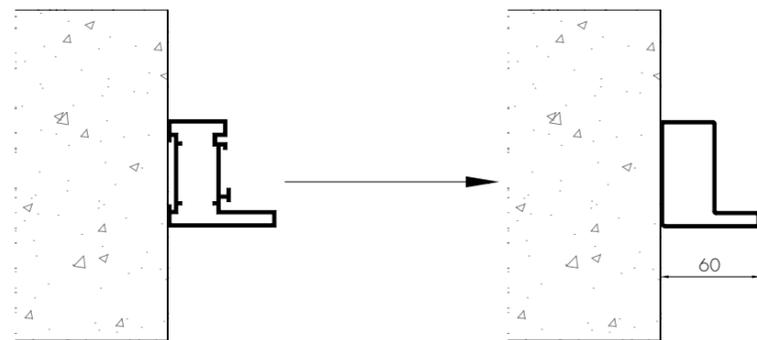
**Caso indicato per il montaggio in sostituzione su stipse in legno, marmo o muro vivo**
